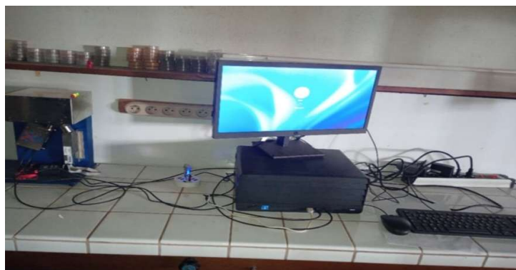
Figure 1: Dispositif de spectromètre de fluorescence X (Amptek EXP-2) utilisé pour l'analyse des échantillons de nouilles.
