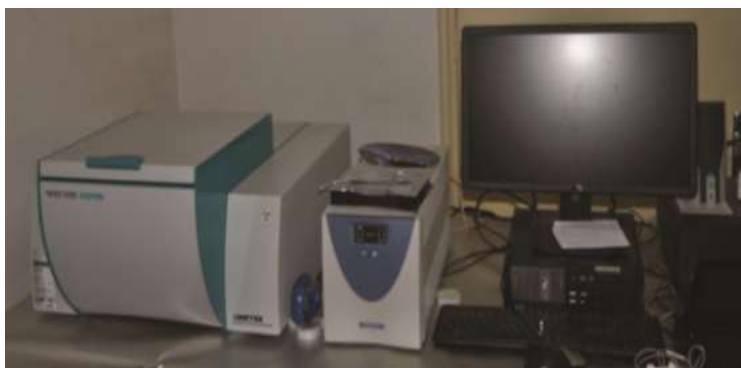
Figure 1 : Spectromètre de fluorescence X SPECTRO XEPOS
