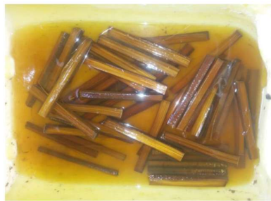
Figure 11: Lamelles de bambou immergées dans la solution de soude
