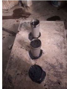
Figure 25: Vibrage des éprouvettes sur la plaque vibrante
