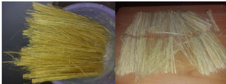
Figure 13: Fibre bien séparée après le peignage suivi d'un séchage
