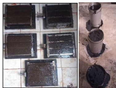
Figure 24: Dressage du béton frais dans les moules
