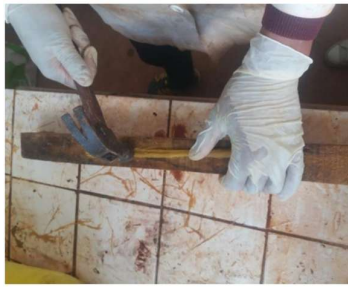
Figure 12: Broyage mécanique des bâtonnets à l'aide d'un marteau
