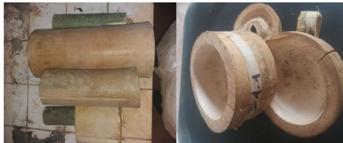
Figure 9: Enlèvement des nœuds de bambou
