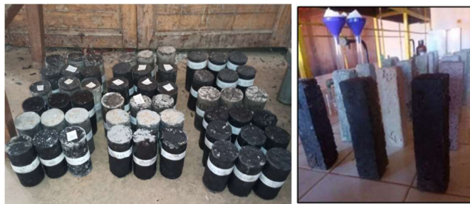
Figure 26: Séchage des éprouvettes
