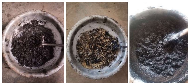
Figure 23: Mélangeage de tous les constituants de notre béton fibré géopolymère
