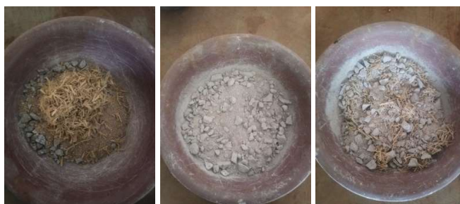
Figure 21: Mélangeage de l'aluminosilicate avec les agrégats et les fibres
