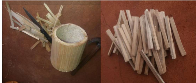
Figure 10: Enlèvement des épidermes et confection des bâtonnets
