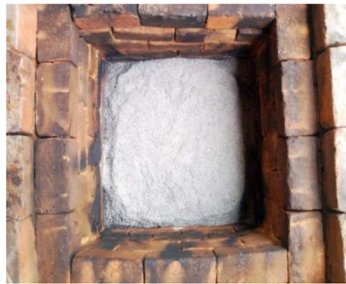
Figure 5: Obtention de cendre de couleur gris riche en silice
