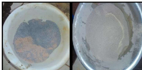
Figure 20: Obtention de l'homogénéité de l'aluminosilicate
