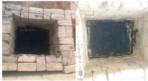
Figure 4: Etape de carbonisation des balles de riz
