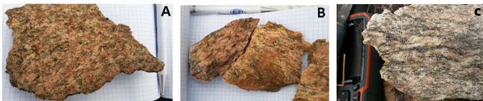
Figure 9. Planches A & B : Vue macroscopique de l'échantillon NB 97 ; gneiss granitique, de couleur rose, grossièrement grenue, exposant de gros grains de microcline, qui est le feldspath le plus abondant dans la roche, également des grains de quartz et quelques minéraux phylliteux.
