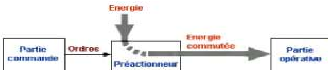
Figure 1 : Schéma bloc d'un relais
