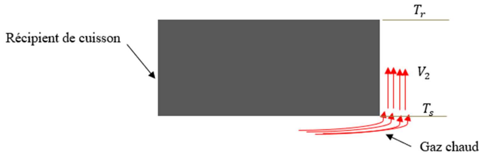
Fig. 2. Écoulement du gaz chaud le long de la paroi verticale du récipient de cuisson
