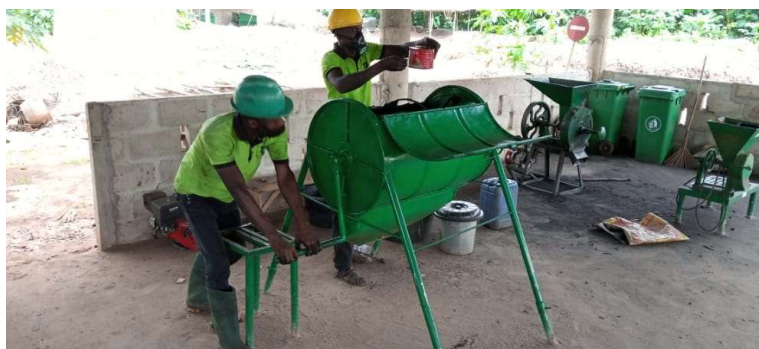
Photo 8 : Mélange du poudre carbonisé avec du liant
