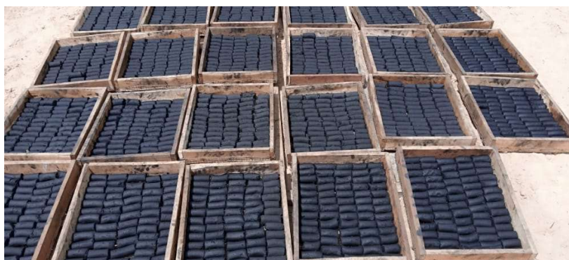
Photo 10 : séchage des briquettes de charbon vert
