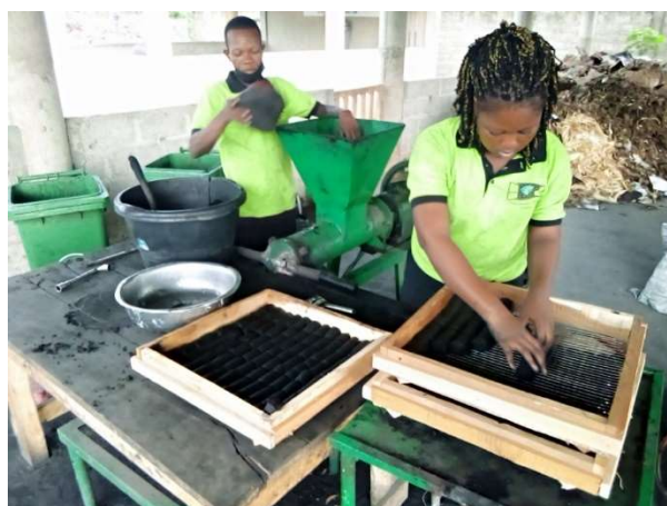
Photo 9 : Pressage des poudres carbonisées après malaxage
