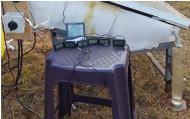
Photo 3. Distillateur avec les instruments de mesure et de contrôle
