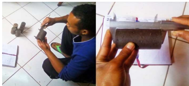
Photo 1 : Mesure des dimensions à l'aide d'un pied à coulisse
