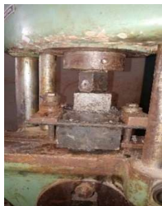
Photo 12 : Pressage de l'éprouvette
