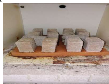
Photo 16 : Eprouvettes après cuisson
