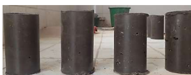
Photo 14 : Séchage des éprouvettes cylindriques d'élancement 2
