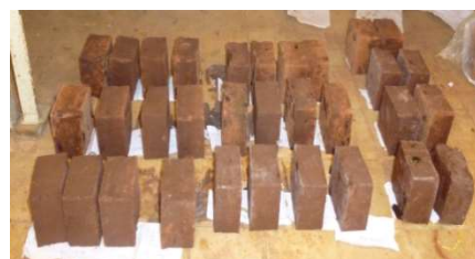
Photo 14 : Séchage des éprouvettes cubiques 6x6x6cm
