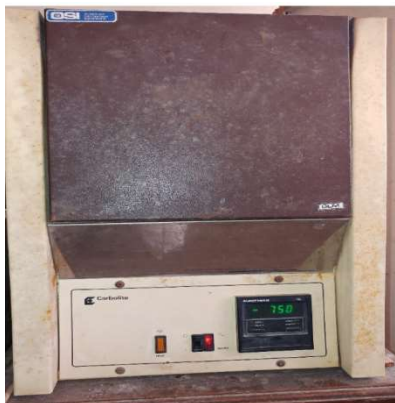
Photo 1: Calcination du Kaolin à 750°C
